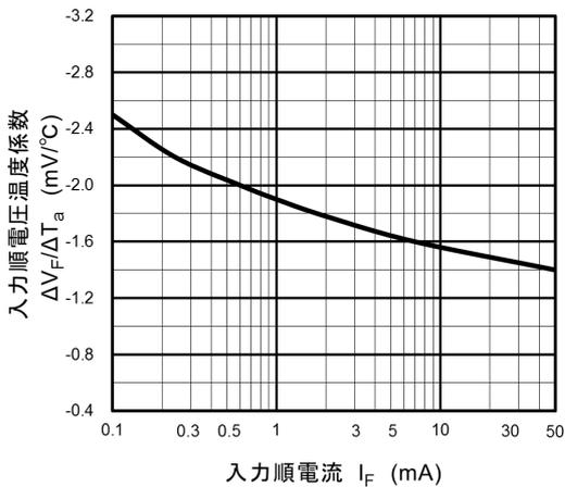
図 12.5  $\Delta V_F / \Delta T_a - I_F$
