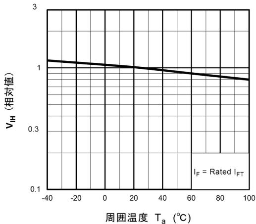
図 12.11 相对  $V_{IH} - T_a$
