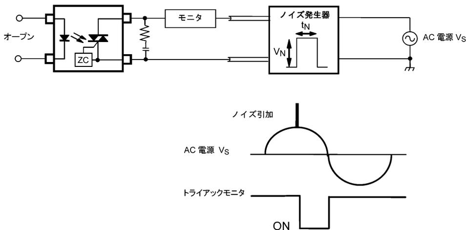
図 10.1 インパルスノイズ測定回路
