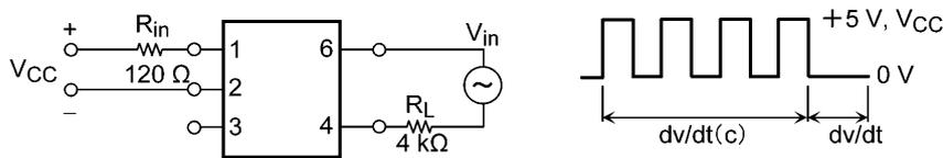
図 9.1 dv/dt測定回路
