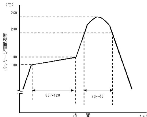
図 13.1.2 鉛フリーはんだ使用時の温度
