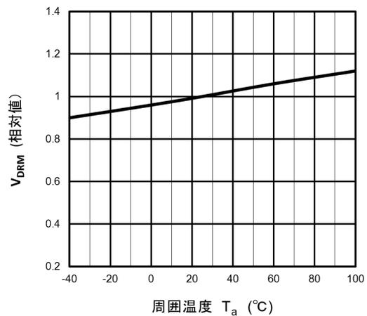
図 12.10 相对  $V_{DRM} - T_a$
